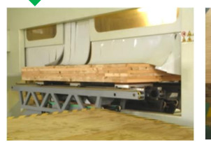
図面と加工機のモニターを見ながら機械で加工します。パネルは固いためゆっくりと加工します。
