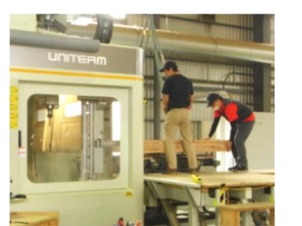
CLTパネルを吊り上げ加工機に入れます
